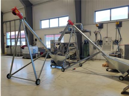
Der EASYTOAST ist eine selbstständige vollautomatische Kompaktanlage. Sie benötigt keinen Einbau in ein System, verfügt über eine eigene Befüllung und Entleerung. In der Auslieferungsversion ist EASYTOAST sofort einsetzbar.
