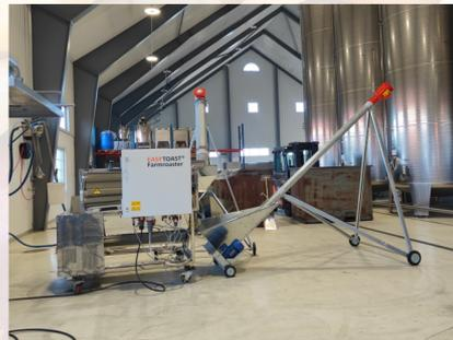
Die Wärme wird hoch effektiv mit Strom in einer rotierenden Trommel erzeugt.
