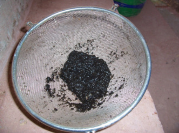
Absatz nach Leitungsspülung
