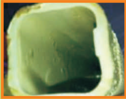
Przewód wody do poidła dla brojlerów po 35 dniach
